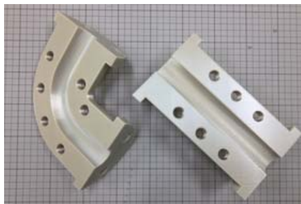
図1. 3Dプリンタにより試作した樹脂型
