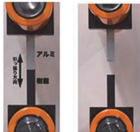
規格化された樹脂－金属 接合強度評価法 (引っ張り接合強度の測定)
